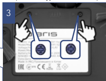
Батареялық бөлік қақпағының бұрамашегелерін бұрап шығарыңыз және қақпақты шешіп алыңыз.
