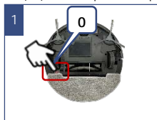
Аспапты I/O ауыстырып-қосқышпен «О» жайғасымға ауыстырып сөндіріңіз.
