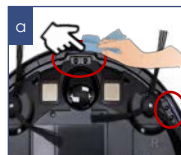
ИҚ датчиктерді абайлап сүртіңіз
